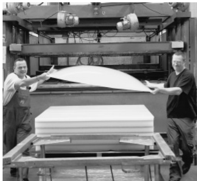
Stapelweise: Zwei Jet-Mitarbeiter holen eine fertige Lichtkuppel aus der Presse. 50.000 Stück werden hier pro Jahr gefertigt.
